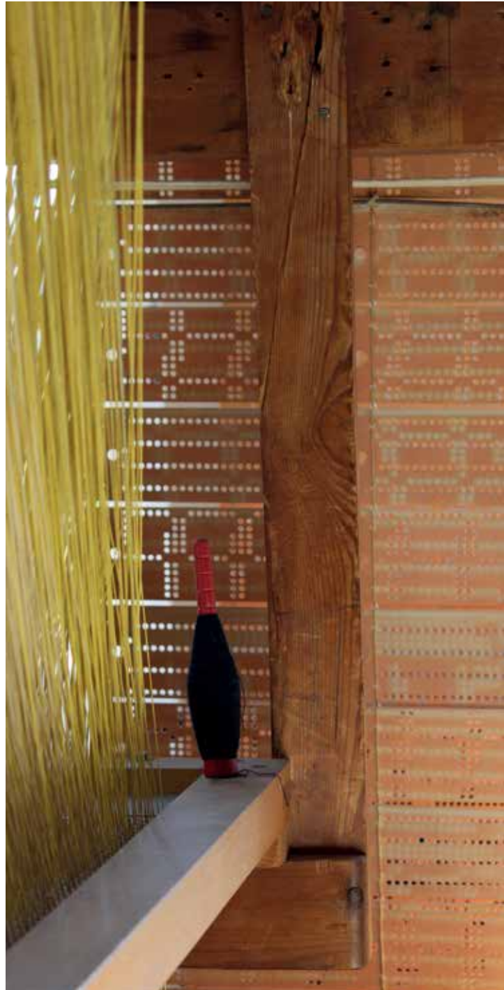
Abb. 25: Jacquardwebstuhl mit Lochkartenlauf, Harnischschnüren und Spule zur Kettfadenreparatur, Beiderwandweberei Meldorf. Foto: Wolfgang Sternberg 2020.
